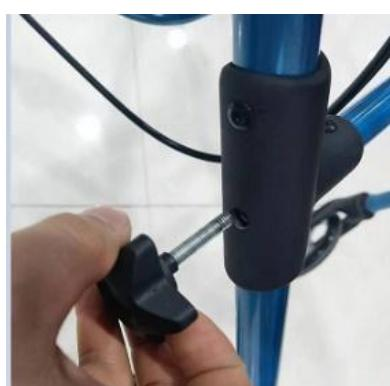
Repita esta operación en la parte trasera insertando las patas traseras en el marco trasero de ambos lados, luego asegure con las tuercas.
