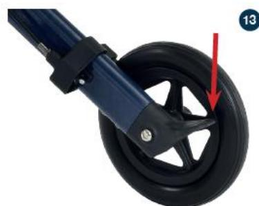
Recomendamos el uso del pisador para superar obstáculos (ver figura 13). Esto le ahorra tener que levantar el rollator sobre obstáculos como umbral y bordillos. Al presionar el pisador y tirar de las asas, levantarás las ruedas de tu rollator y podrás sortear fácilmente los obstáculos.
