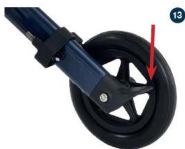
Nous vous recommandons d'utiliser notre passe-trottoir intégré (voir figure 13). Cela vous évite de devoir soulever le rollator pour franchir des obstacles tels que les seuils et les bordures de trottoir. En appuyant sur le passe-trottoir et en tirant sur les poignées, vous soulèverez les roues de votre rollator et vous franchirez facilement les obstacles.
