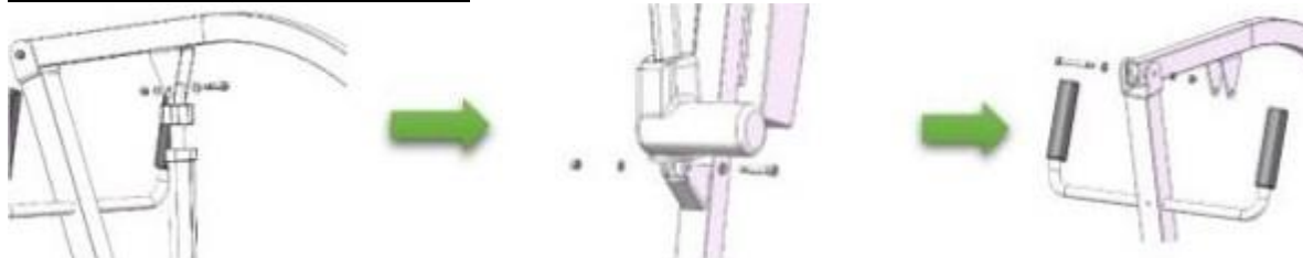
Fig. 3 Instalación del brazo elevador
