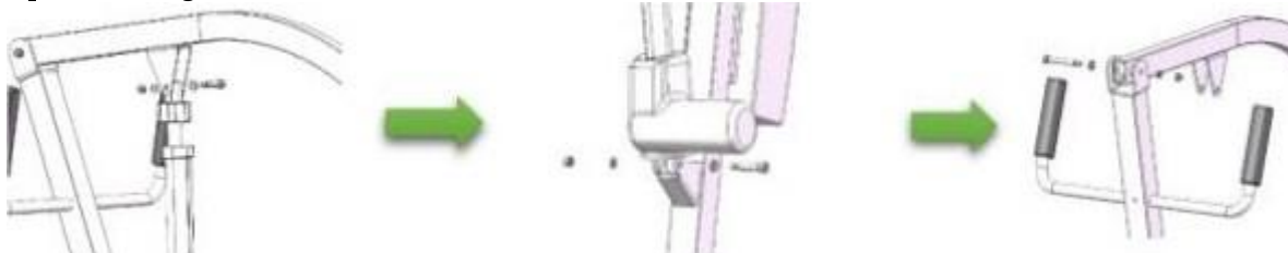
Fig. 3. Installation du bras de levage
