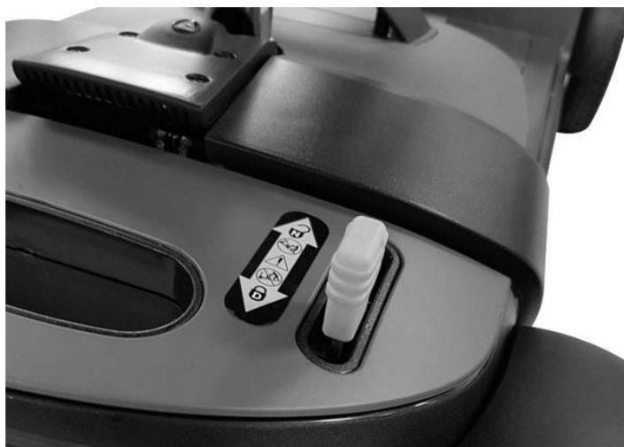
**Attention ! Ne laissez jamais le scooter sans surveillance en mode roue libre, car il risque de rouler sur une pente. Le mode 'roue libre' ne doit être utilisé qu'en cas d'urgence pour déplacer l'appareil à cause d'une panne. NE JAMAIS déplacer le scooter dans ce mode lorsqu'il est occupé. Ne remorquez JAMAIS le scooter.**
