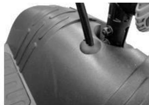
Para montar la tija de sillín, es necesario desmontar la parte trasera del scooter para acceder al tornillo de fijación. Localice la tija y alinee los orificios en el bastidor y el montante a la altura deseada. Apriete el tornillo con la llave Allen y la llave suministrada. Vuelva a montar la parte trasera del scooter.
