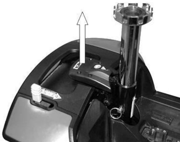
Para volver a montarlo, deje que la sección trasera del scooter descance boca abajo sobre las ruedas antivuelco. Levante la sección delantera por la tija del sillín hacia atrás y coloque las "orejas" a ambos lados del bastidor sobre el tubo principal de la sección trasera, tal como se muestra a continuación. Ahora puede bajar suavemente la sección delantera hasta su posición.
