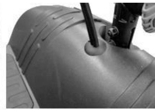
Pour monter la tige de selle, la partie arrière du scooter doit être retirée pour accéder au boulon de fixation. Repérez la tige de selle et alignez les trous dans le cadre et le montant à la hauteur souhaitée. Serrez le boulon à l'aide de la clé Allen et de la clé fournie. Remontez la partie arrière du scooter.
