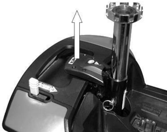
Pour le remontage, laissez la partie arrière du scooter reposer à l'envers sur les roues anti-bascule. Soulevez la section avant par la tige de selle vers l'arrière et placez les "oreilles" de chaque côté du châssis sur le tube principal de la section arrière comme indiqué ci-dessous. L'avant peut alors être doucement abaissé en position.
