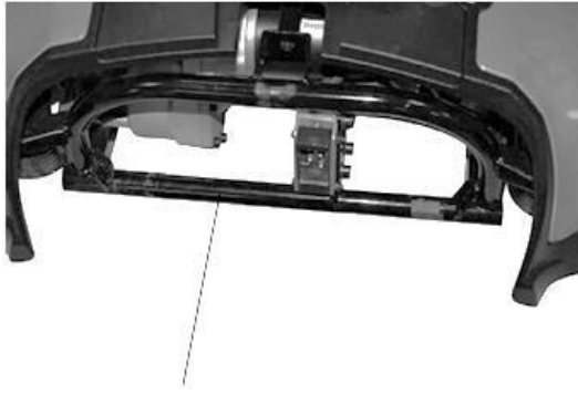
Tubo principal do quadro traseiro
