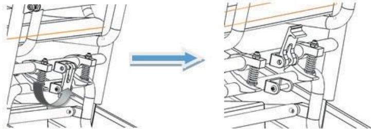
Paso 2: Comprimir el tubo del respaldo para que esté completamente plegado.
