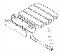
6. Visser le siège de douche grâce aux deux vis à tête plate M4X8L
